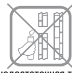
недостаточная тяга (Не используйте котел!)
