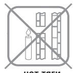
нет тяги (Не используйте котел!)
